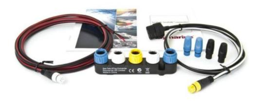
En este caso tendremos que cortar el cable de seatalk1 que viene en el kit, y que tiene conector amarillo al final.. y conectar su cable rojo interior con el marrón de la caja del control remoto, el negro con el cable azul y el amarillo con el verde y amarillo.
